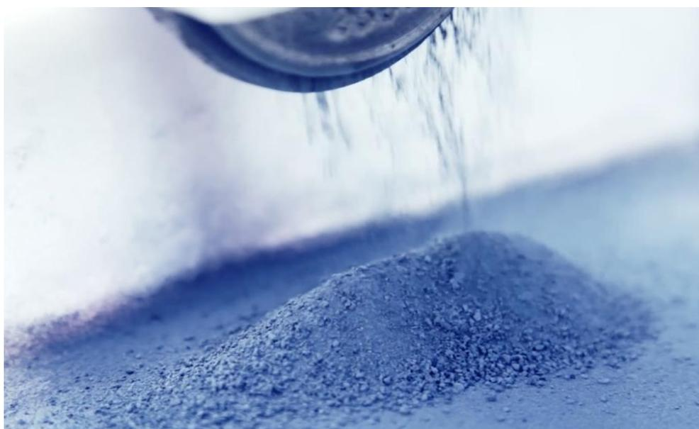
**Figura 7:** Corante natural índigo em forma de pó após processo de moagem dos blocos precipitados.
