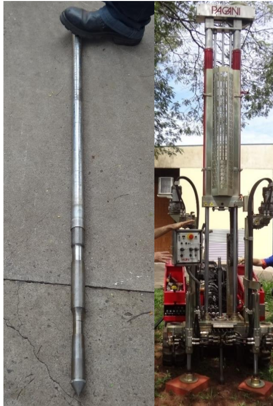
Figura 1.1: exemplo de piezocone (lado esquerdo) e equipamento para a cravação do cone no terreno (lado direito). Fonte: Abreu (2011).
