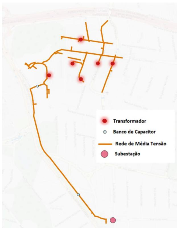
**Figura 5.20: Diagrama georreferenciado do alimentador e dos transformadores MT/BT com consumidores com transgressão de tensão acima do limite.**
