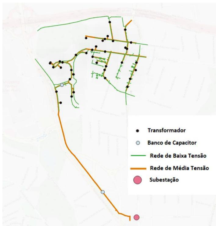
Figura 4.2: Diagrama georreferenciado do alimentador A.
