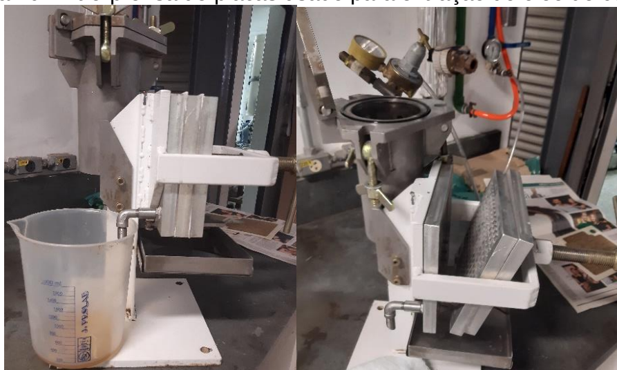
Figura 10: Filtro-prensa de placas usado para extração do óleo de coentro.
