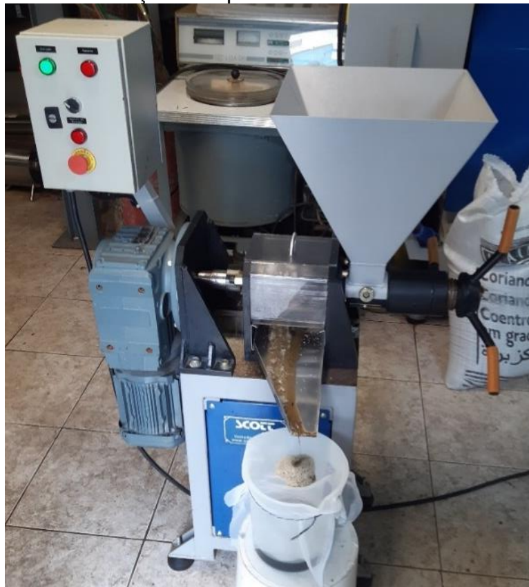
Figura 15: Processo de extração com prensa.
