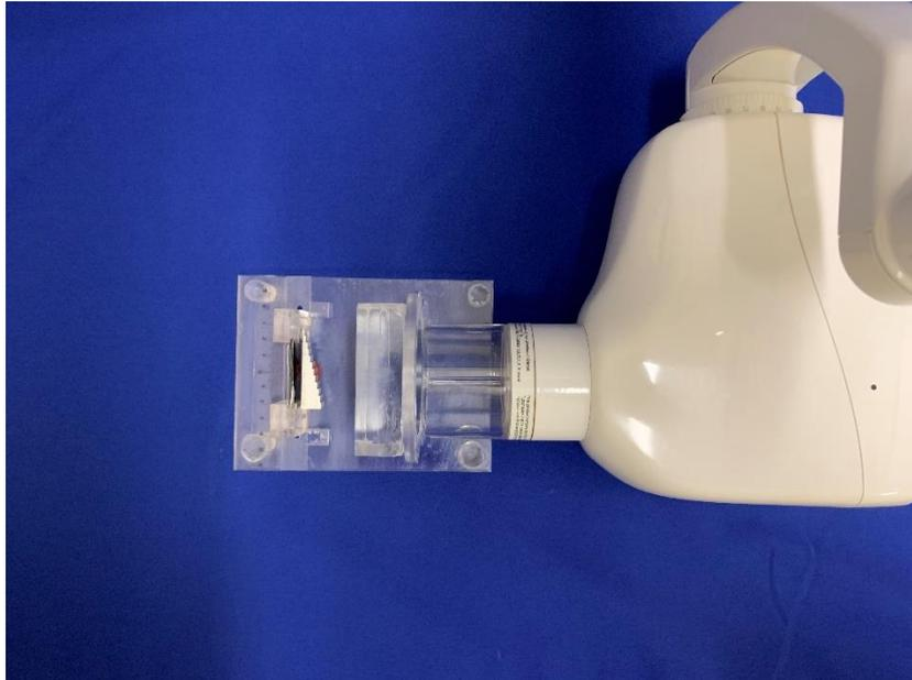
Figura 1 - Representação do cone localizador em contato direto com o arco acrílico do dispositivo. Escala de alumínio em posição
