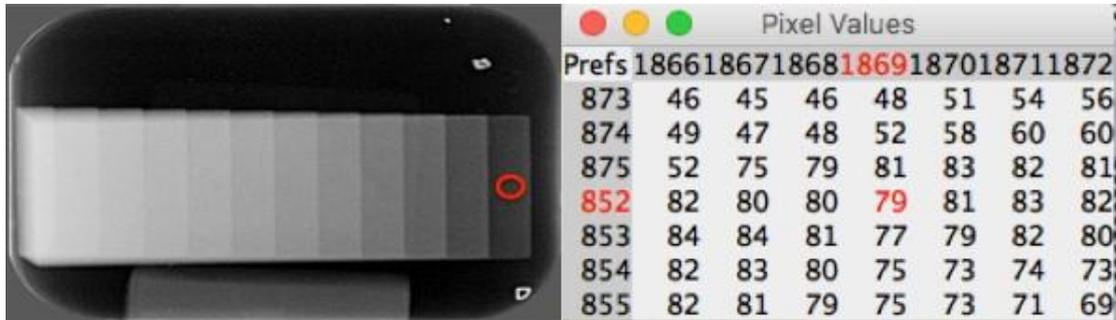
Figura 2 - Escala de alumínio de 12 degraus. Valor do pixel do primeiro degrau
