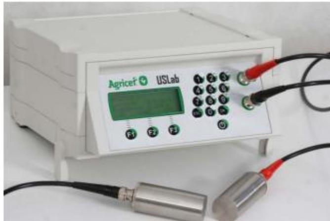
Figura 2.1: Equipamento ultrassônico USLab. Fonte: (CERRI, 2010)
