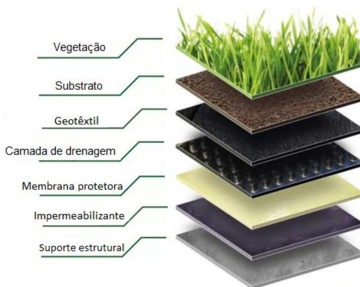
Figura 3: Representação de um modelo de cobertura verde e sua possível composição.
