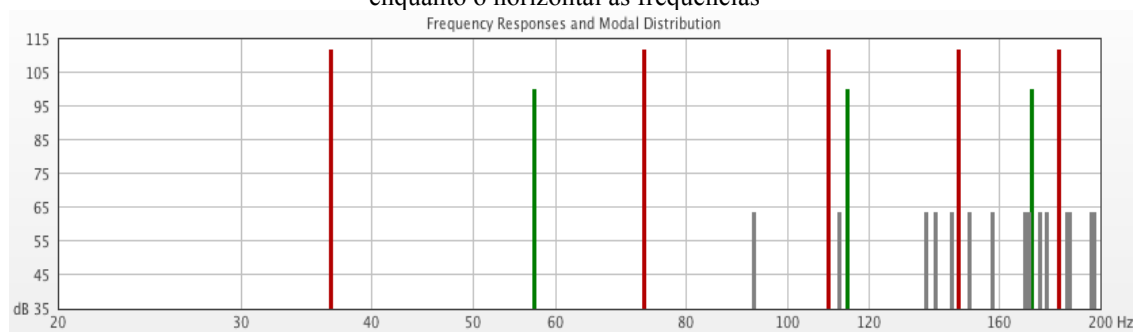
Figura 19 - Gráfico demonstrativo dos modos axiais referentes ao comprimento e a largura da sala, vermelho e verde respectivamente e modos oblíquos na cor cinza. O eixo vertical refere-se à intensidade, enquanto o horizontal às frequências
