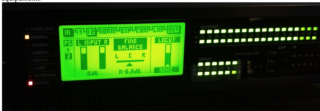
Figura 17 - Filtro Low cut do Tc Finalizer ajustado em 32 Hz. O Fine balance ajustado em - 0.2 é uma compensação do equilíbrio da imagem estéreo alterada pela passagem do áudio pelo compressor analógico. Como esse desequilíbrio é constante, não se trata de uma exceção e sim de ajuste default no equipamento
