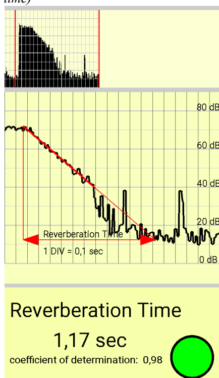
Figura 7 - Medição do tempo de reverberação ( RT_{60} ) do hall da escada. Média entre três medições realizadas por meio do app Nachhallzeit (Reverberation time)
