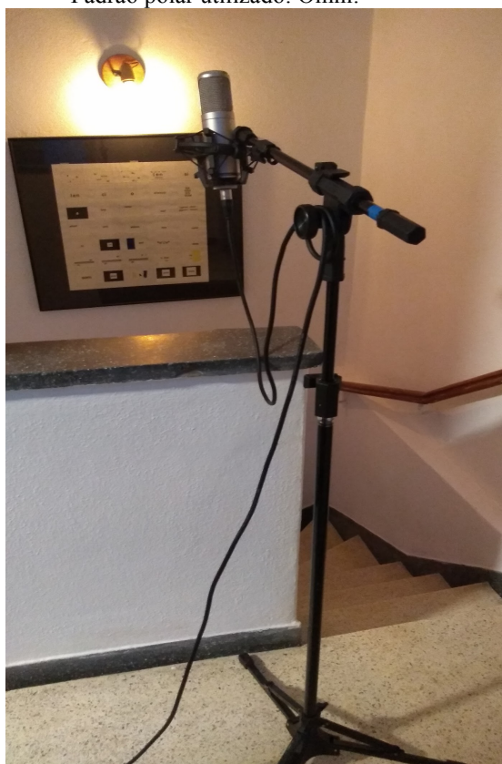
Figura 9 - Microfone Røde K2 utilizado no hall da escada para captação da ambiência. Padrão polar utilizado: Omni.
