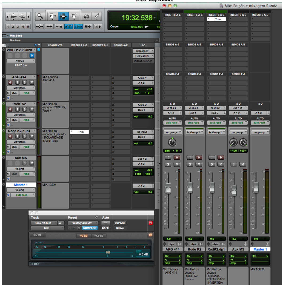
Figura 13 - Sessão do Pro Tools . Demonstração da aplicação do sistema matrix na sessão de mixagem do projeto de gravação da obra Ronda . O plug-in Trim foi utilizado para inverter a polaridade do canal Side duplicado
