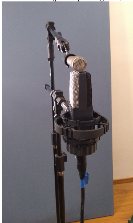
Figura 10 - Técnica M/S de microfonação. O microfone superior utilizado para a captação do som direto da fonte pode ser unidirecional ou multidirecional ( omni ), já o microfone inferior é sempre bidirecional (padrão polar figura 8).
