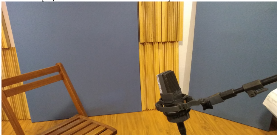
Figura 8 - Microfone AKG 414 XLS utilizado na sala de gravação para captação do som direto do violão. Padrão polar utilizado: Cardióide.
