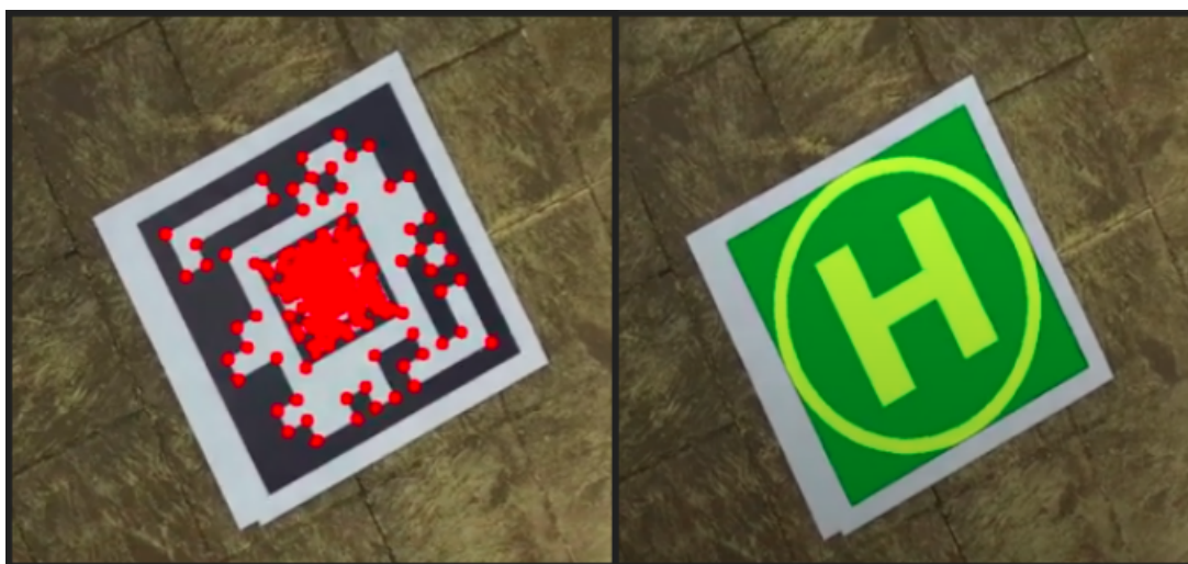
Figura 2.3: Aplicação do marcador Fractal Markers em pousos autônomos, F. Romero-Ramirez et al. (2019).
