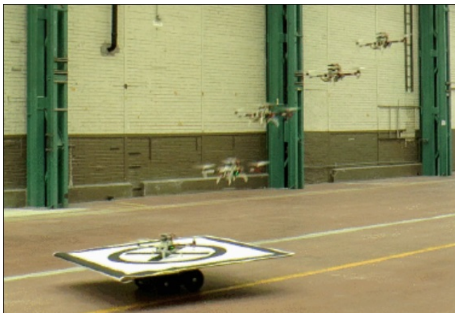
Figura 1.1: Quadrotor pousando em uma plataforma móvel, (FALANGA ET AL., 2017).
