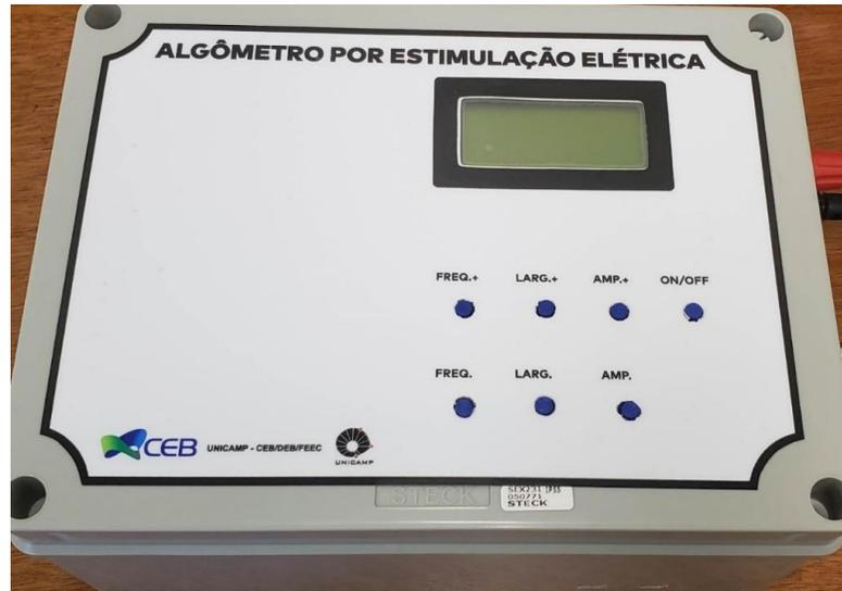
**Figura 19.** Tela LCD e painel de controle do algômetro elétrico.
