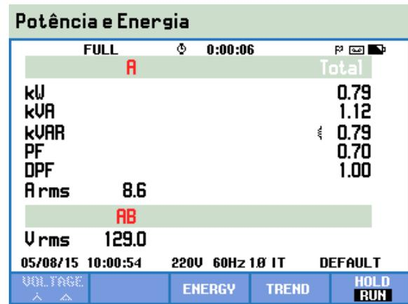
Figura 12. Grandezas elétricas medidas do motor em paralelo com 29 LFCs.
