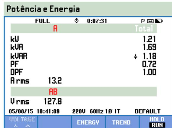
Figura 8. Grandezas elétricas medidas do conjunto motor em paralelo com as 48 LFCs.
