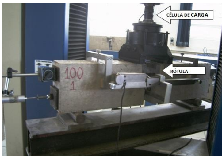
Figura 7 - Detalhe do ensaio de flexão
