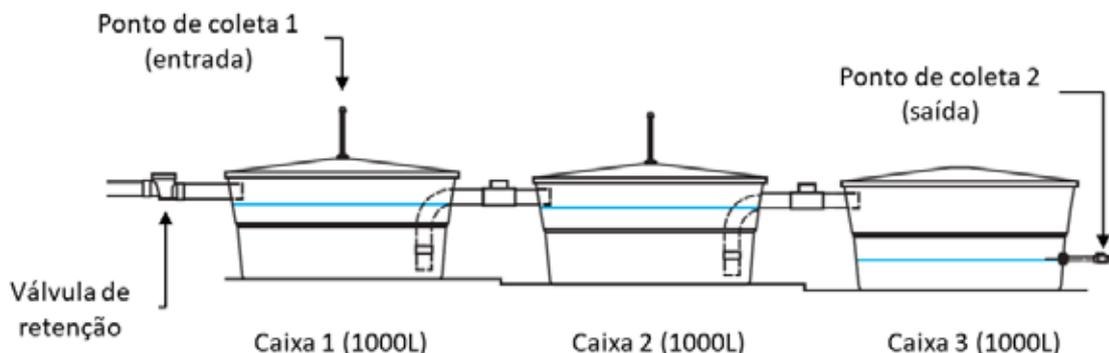
**Figura 2** - Esquema da Fossa Séptica Biodigestora (FSB) implantada. Os pontos *entrada* e *saída* assinalam os pontos de coleta de amostras para avaliação do sistema. Fonte: Adaptado de Silva, Marmo e Leonel (2017).
