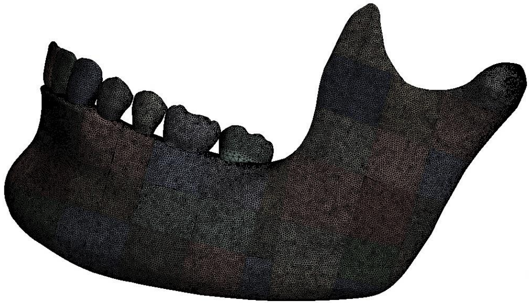
Figura 3 - Vista lateral da geometria obtida da mandíbula importada ao software Ansys v14 (Ansys, Inc.) no qual foi construída a malha tridimensional de elementos finitos.
