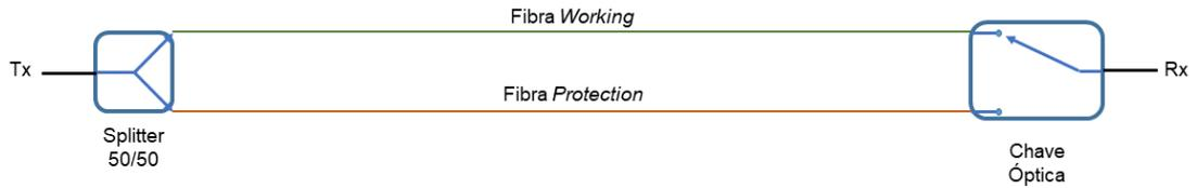
Figura 1 – Mecanismo de proteção 1+1.
