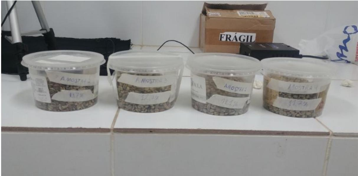
As amostras restantes passaram pelo processo de secagem. A umidade final do café para comercialização é em torno de 11,5%, diante disso foi retirado uma amostra na metade do processo de secagem, essa amostra passou pelo medidor de umidade e dessa amostra, 5 grãos passaram pelo biospeckle.
