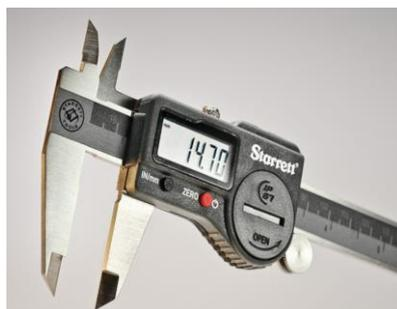
Figura 1: Paquímetro Digital usado para medir a distância entre os bráquetes
