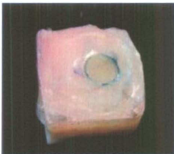
Figura 7. Amostra após imersão na solução de azul de metileno 2%.
