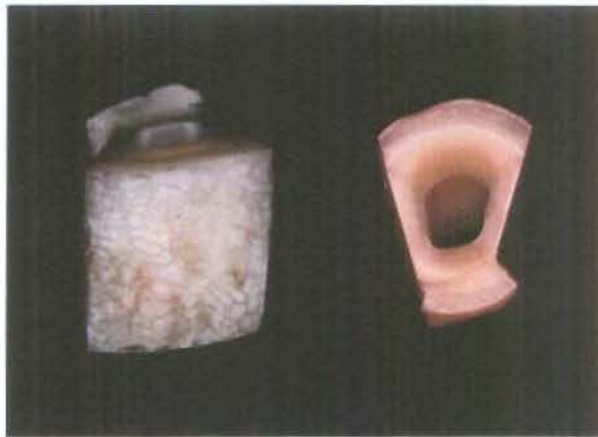
Figura 4. Bloco de dente bovino cortado com disco diamantado
