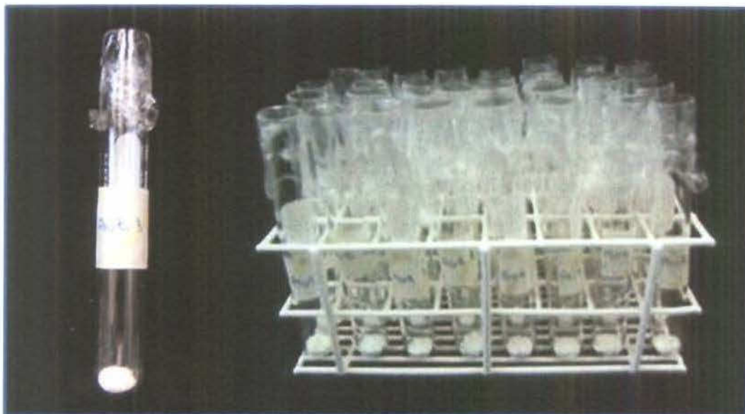
Figura 9. Amostras trituradas e inseridas dentro dos tubos de cristal.
