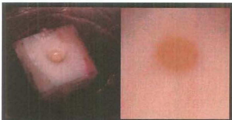
Figura 6. Amostras incluídas em resina de poliestireno, à esquerda, amostra com cavidade preparada; à direita, restauração concluída
