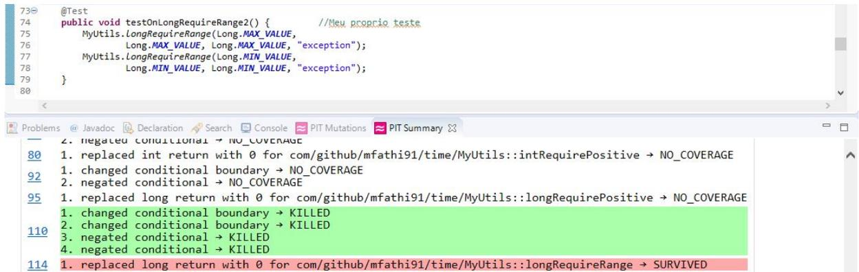
**Figura 14:** Resultado da morte dos mutantes do tipo *changed conditional boundary* da linha 110 quando aplicada a técnica de análise dos valores limites criando o caso de testes `testOnLongRequireRange2`.
