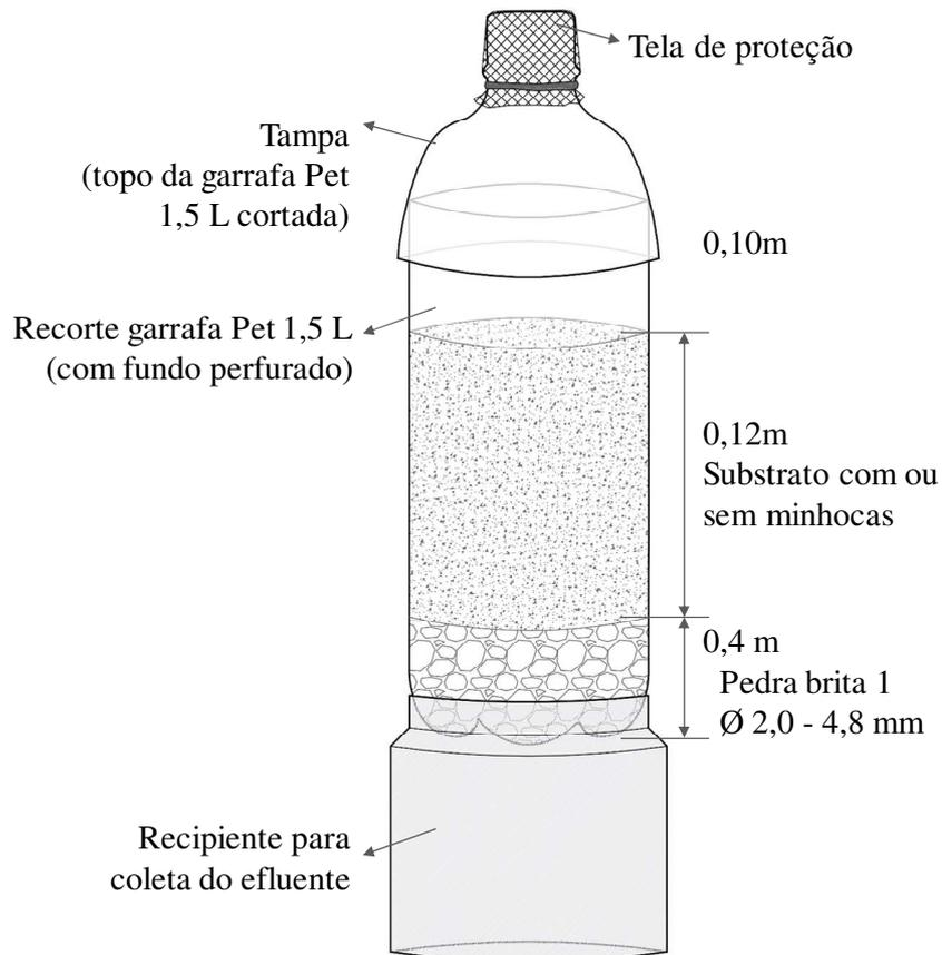
**Figura 1.** Representação esquemática (Fonte: Modificado de Duarte et al., 2017).
