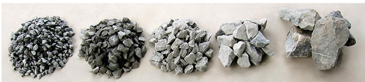
Figura 5 - Agregados Graúdos de Diversas Granulometrias (Brita)
