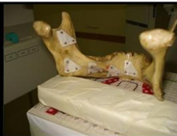
Figura 5- Mandíbula posicionada sobre o phantom com os triângulos na cortical interna
