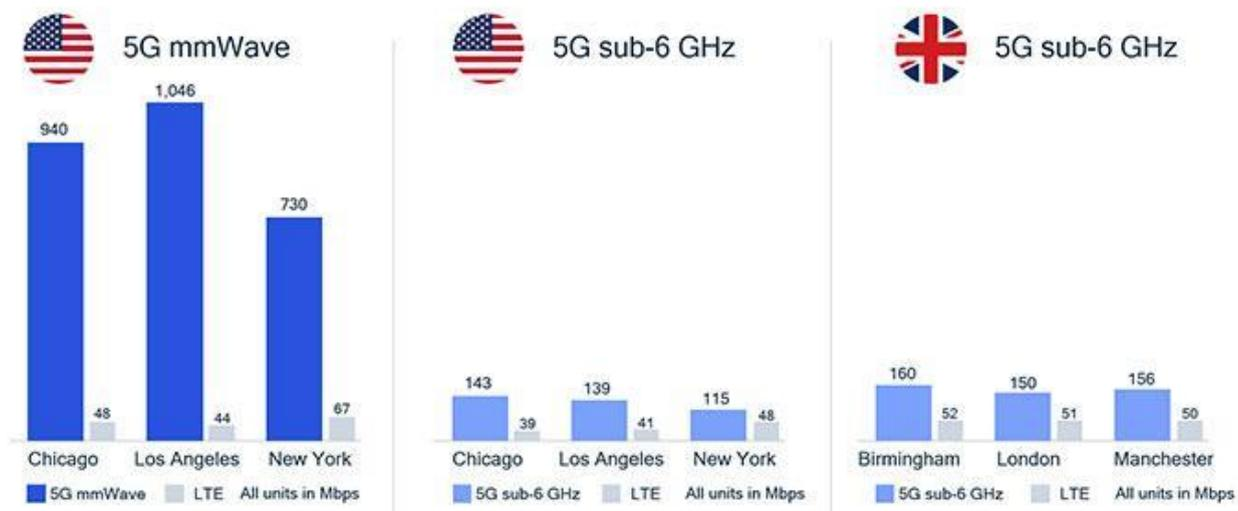
**Figura 5** - Ganhos em vazão de dados em Mbps observado por usuários com conexão 5G *mmwave* [30]
