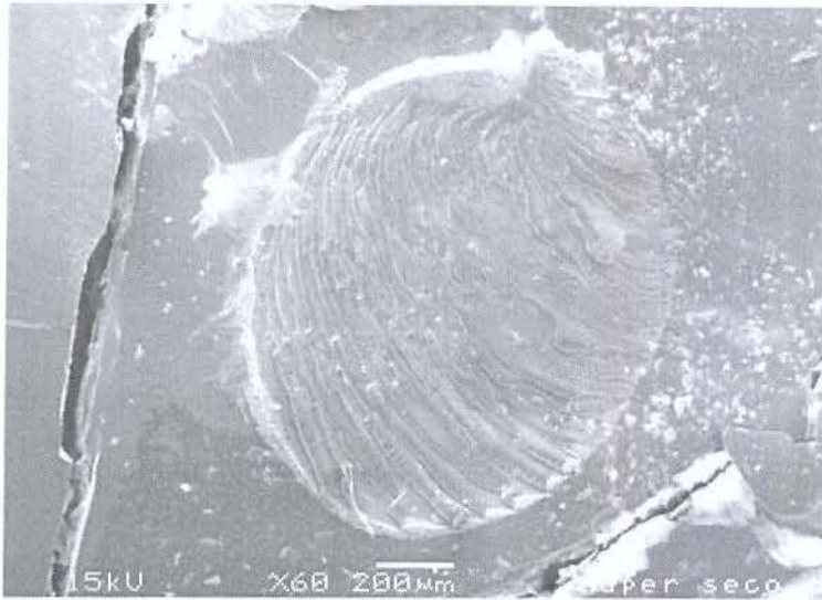
Figura 8. Fratura coesiva do adesivo
