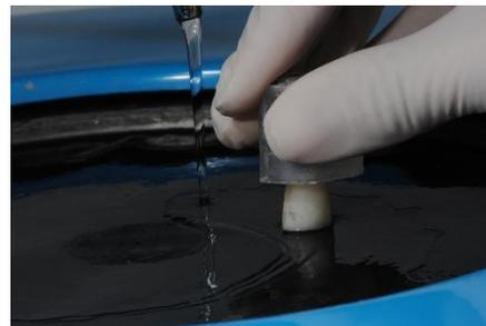
Figura - Amostras lixadas com lixas d’água conectadas à máquina politriz
