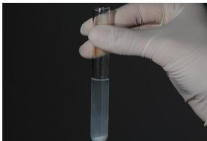
Figura 13 - Pó composto por dente/restauração imerso em tubo de ensaio, contendo 4 ml de álcool absoluto PA
