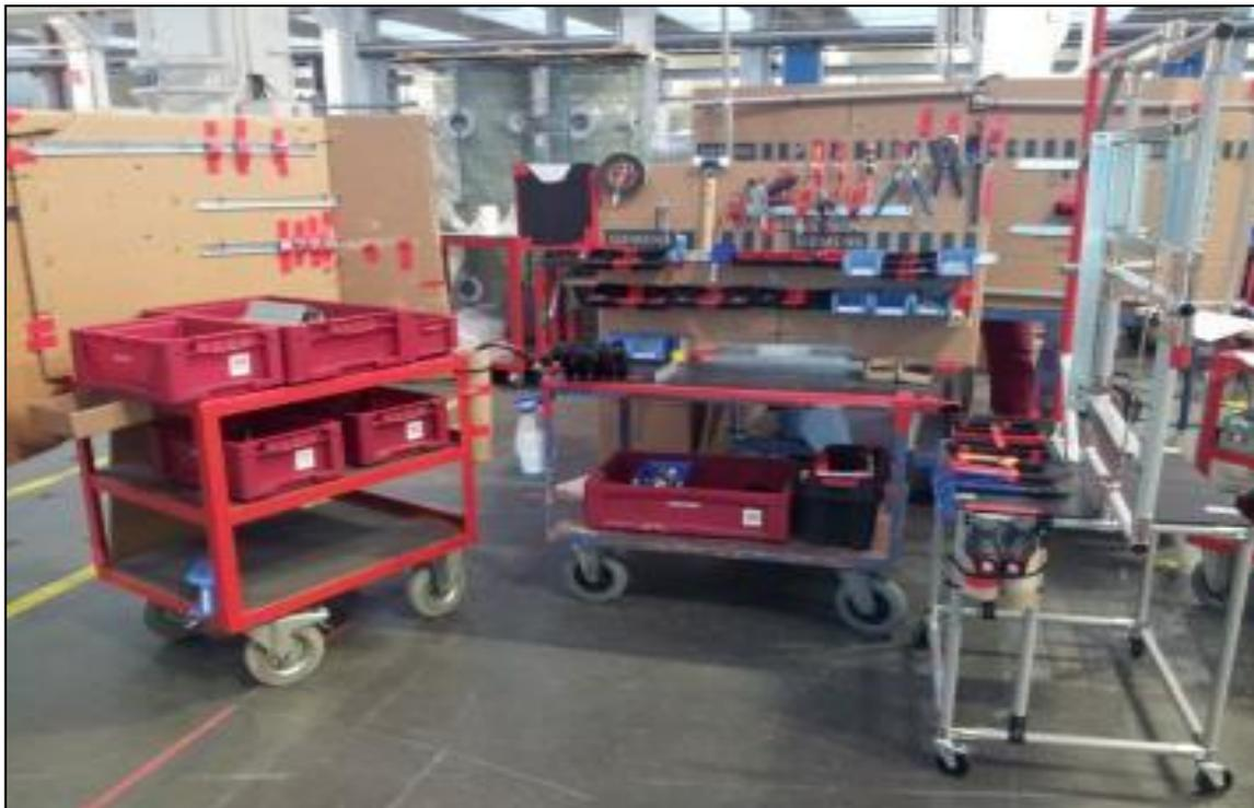
**Figura 14** – Simulação de carrinhos de ferramentas para Mock-up
