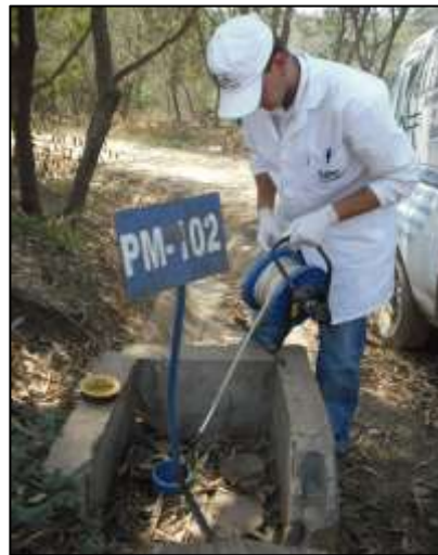
B – Nível de água no poço PM-102.
