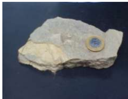
F – Amostra de ritmo silto-arenoso acinzentado encontrado em afloramento no Aterro Delta A.
