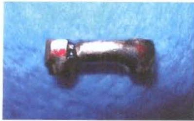
Figura2. Barra de titânio soldada a laser confeccionada para comparação entre as técnicas.
