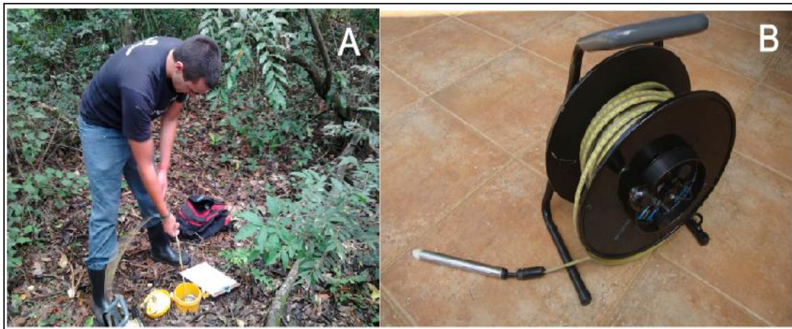
Figura 3.1.1. Foto apresentando a medição do nível d'água no poço 1.3 (A) com medidor eletrônico (B).
