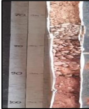
**Figura 22 - Amostra de calha de perfuração entre as profundidades de 70 e 100 m do P28.**
