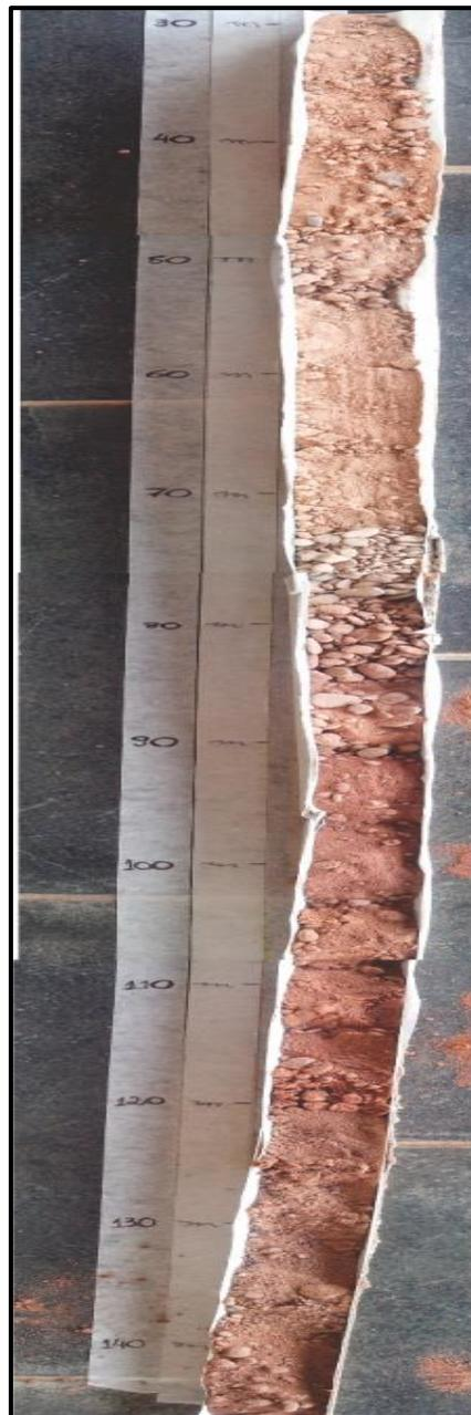
*Figura 25 - Amostras de calha do P28*
