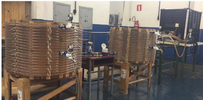
Figura 2 - Rede Piloto com duas bobinas e 1 reservatório. Fonte: Autoria Própria.
