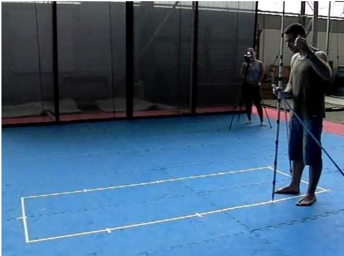
FIGURA 4: Procedimento de calibração – haste móvel filmada para a calibração da área de coleta
