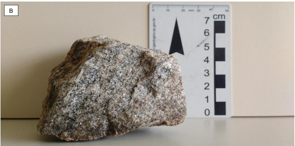
**Figura 11:** Aspectos macroscópico da subunidade Biotita granito com anfibólio. a) Forma de ocorrência em campo; b) Amostra de mão
