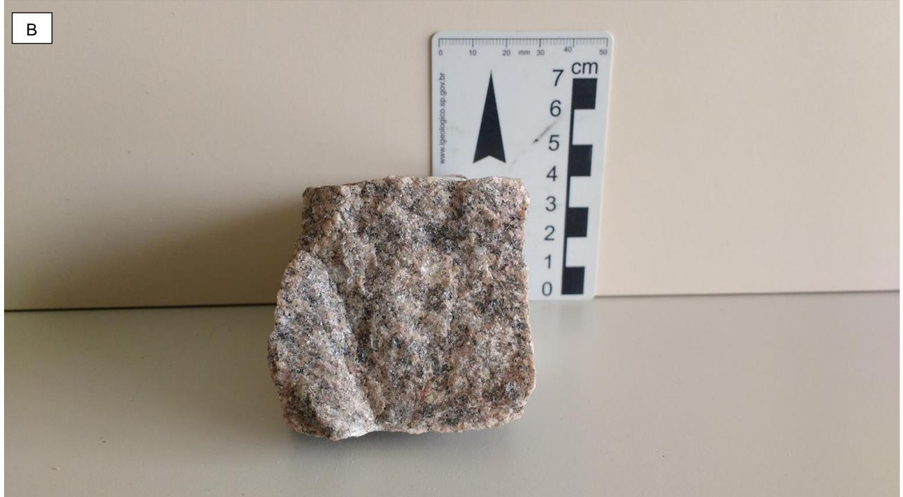
**Figura 9:** Aspectos macroscópico do Biotita granito. a) Afloramento; b) Amostra de mão.
