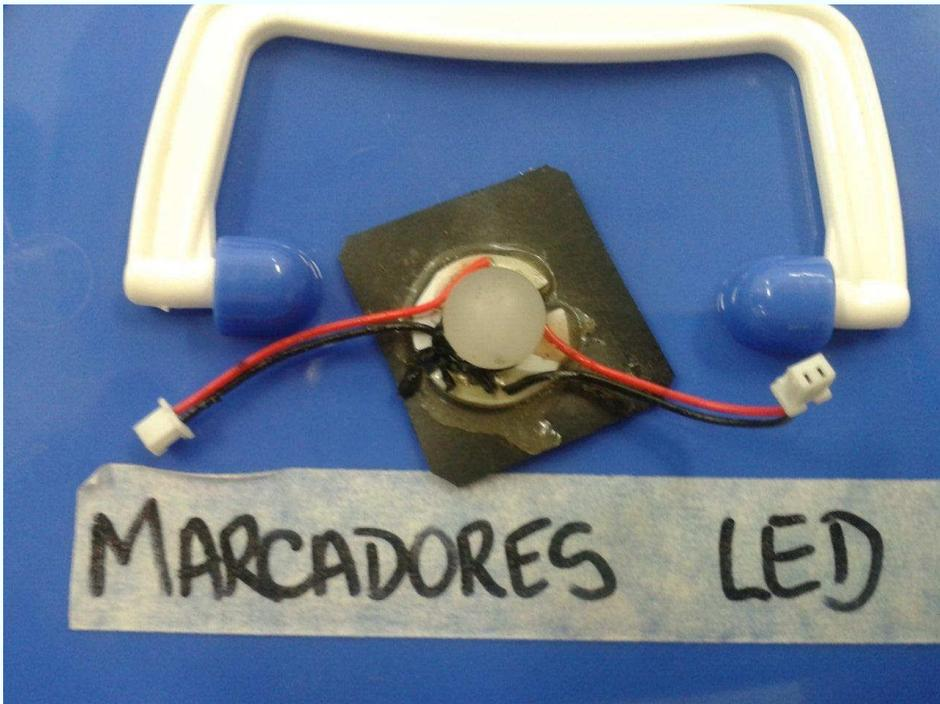
**Figura 1** – Representação dos marcadores de LED utilizados na coleta.
