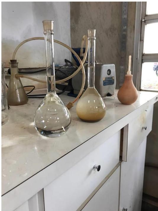
Figura 10: picnômetro com água destilada (à esquerda), picnômetro + água destilada + 50g de solo (à direita) e bomba de vácuo utilizados no ensaio.
