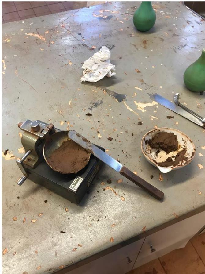
Figura 14: Aparelho de Casagrande utilizado nos ensaios das amostras, preenchido com solo, recém aplainado pela espátula. Ao lado, a concha de porcelana com a amostra ainda a ser utilizada, e a direita, o “objeto” utilizado para realizar a ranhura.
