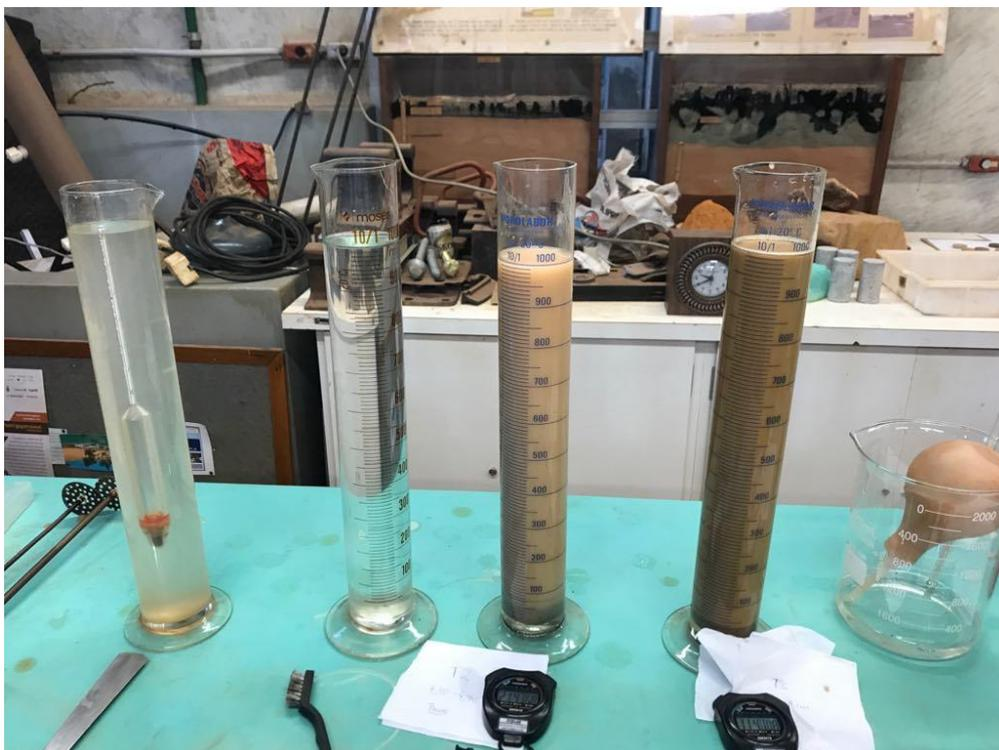
Figura 11: imagem do ensaio realizado. À esquerda, uma proveta com apenas água para deixar o densímetro enquanto não é realizada nenhuma medida; proveta com água destilada + 125ml de defloculante; proveta com soluções com 50g de solo, 125ml de defloculante e o restante preenchida com água destilada.
