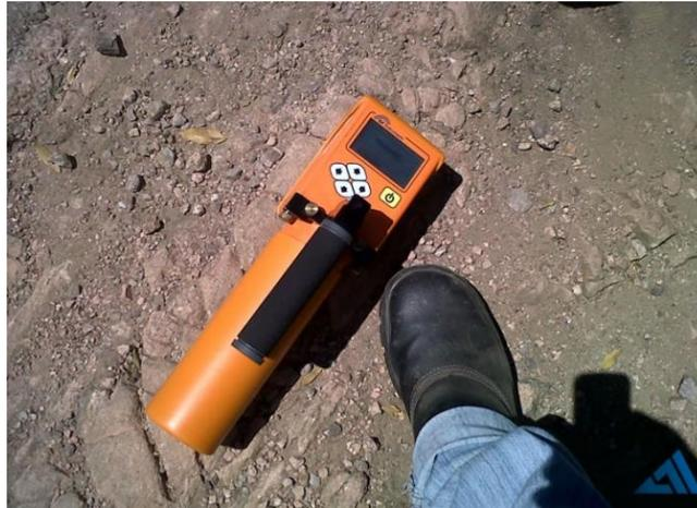
Figura 16: susceptibilímetro utilizado em campo realizando uma medida das concentrações de K,U e Th.
