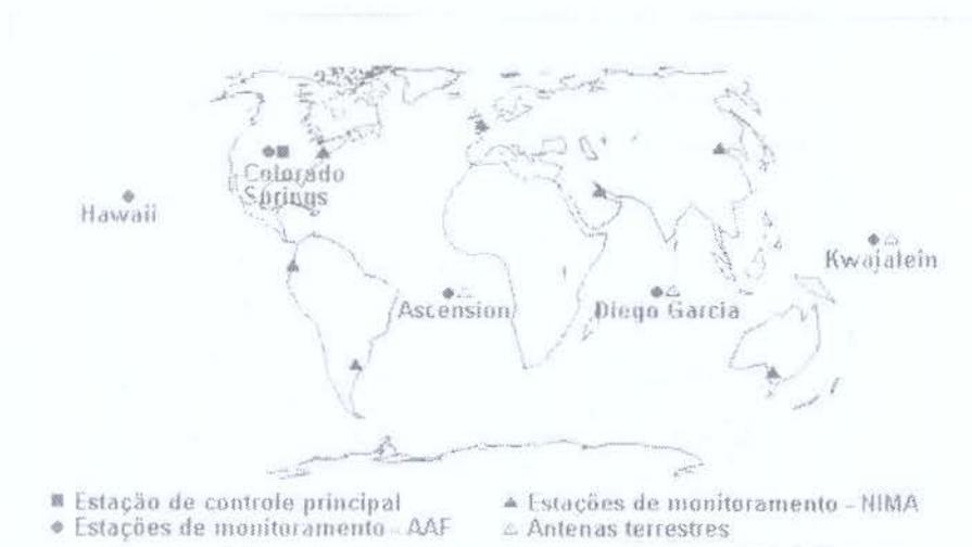
FIGURA 1.7 - Segmento de controle do GPS
