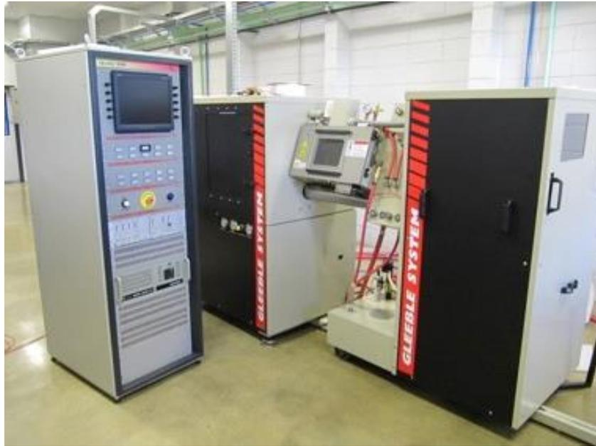
Figura 10 – Simulador termomecânica Gleeble 3800, presente no laboratório Nacional de Nanotecnologia.
