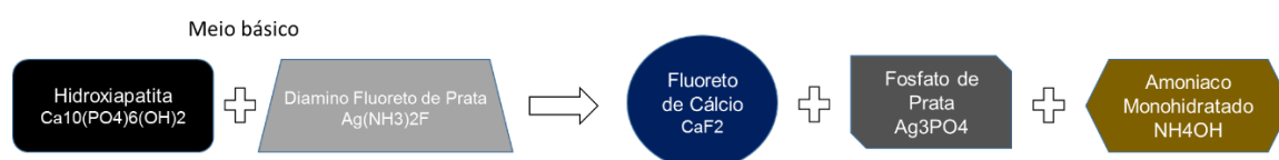
Figura 1: Reação da hidroxiapatita com a solução de diamino fluoreto de prata em meio básico resultando nos produtos como fluoreto de cálcio, fosfato de prata e amoníaco monohidratado.
