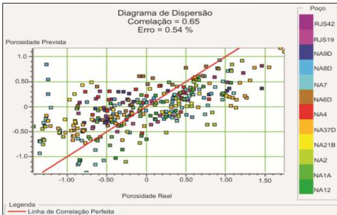
Figura 3.5: Diagrama de Dispersão com todos os poços, mostrando a correlação e o erro do modelo de porosidade gerado.
