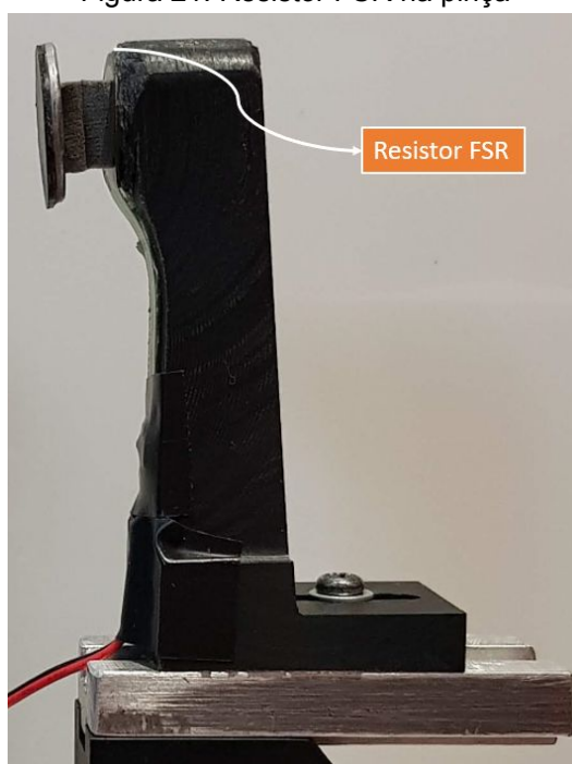
Figura 21: Resistor FSR na pinça
