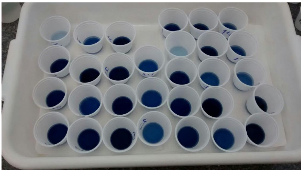
Figura 6.2 - Soluções finais para análise de fosfato e sílica com a cor azul característica.
