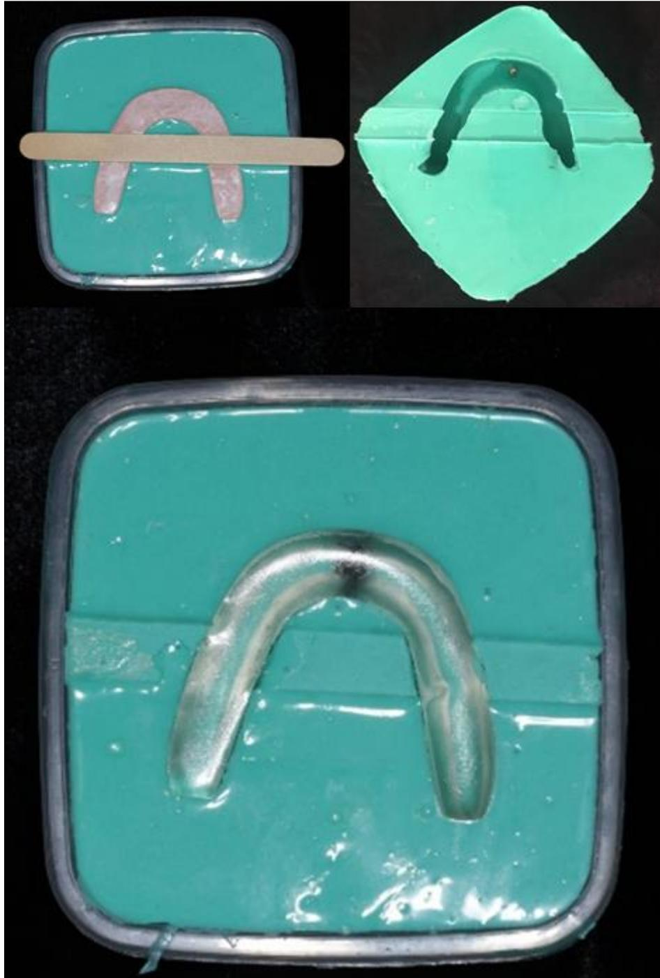
Figura 7- Sequência do preenchimento do molde com resina fotoelástica.
