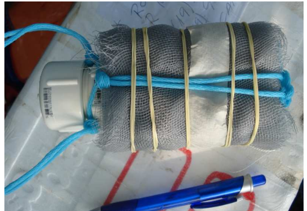
Foto 4: Exemplo de um "peeper" recoberto por tela de nylon.
