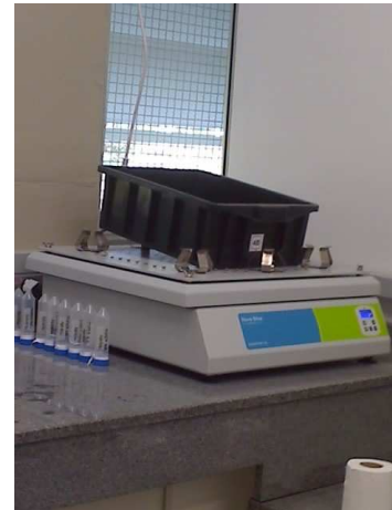
Foto 8: Agitador mecânico utilizado na preparação das amostras para granulometria.
