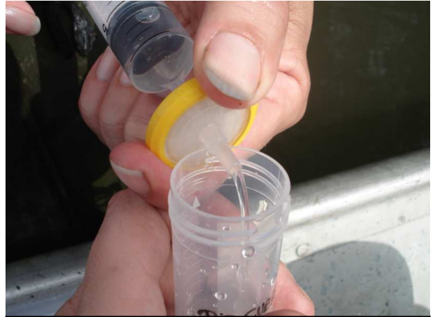
Foto 6: Amostras de água foram filtradas em campo, por membrana de acetato de celulose Millipore, com poros da ordem de abertura de 0,22 \mu\text{m} .
