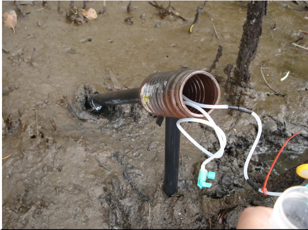
Foto 5: Amostrador tipo “peeper” enterrado no sedimento do mangue. Apenas os canos ficam acessíveis para a realização da coleta da água intersticial.
