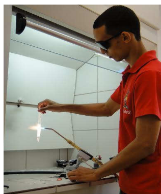
Figura 3. Encapsulamento da peça em tubo de quartzo.
