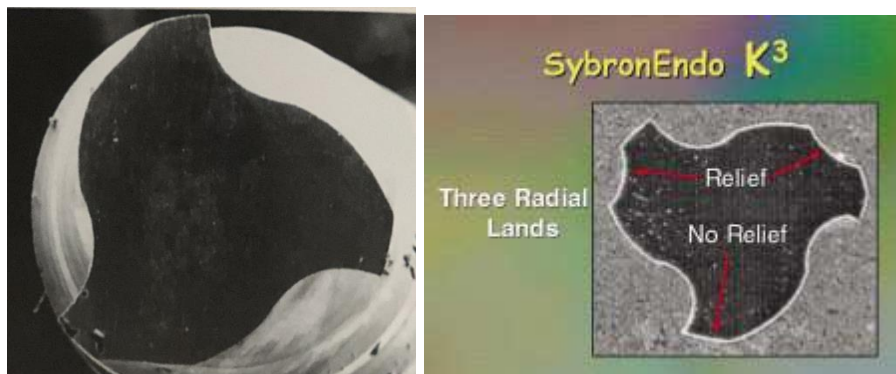
Figura 17: Na imagem vemos a secção transversal triangular modificada dos instrumentos K3. Três guias radiais e os perfis das paredes dos canais sinuosos (Lopes e Siqueira Junior, 2015; Koch e Brave, 2002).
