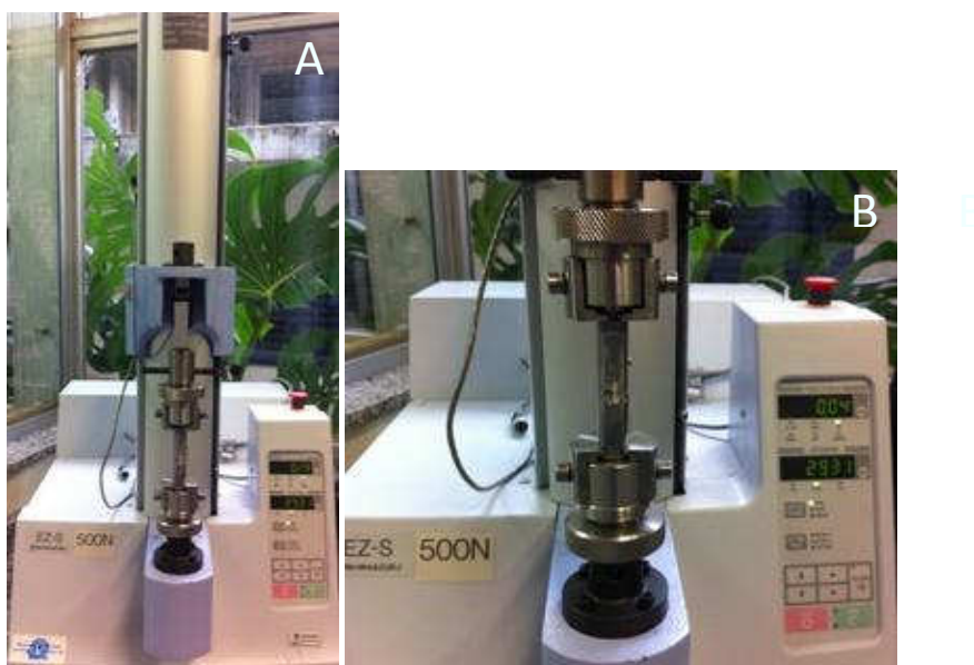
Figura 7. A - Máquina de ensaios EZ test utilizada na avaliação da resistência coesiva por microtração. B – Vista aproximada do dispositivo utilizado para o ensaio de resistência coesiva com ampulheta fixada.
