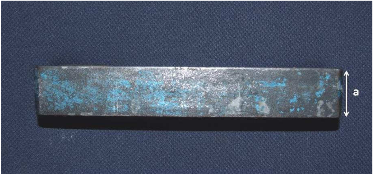
Figura 07 - Molde em metal para inclusão das hemi-mandíbulas – vista lateral. (a) Altura do suporte = 3 cm.
