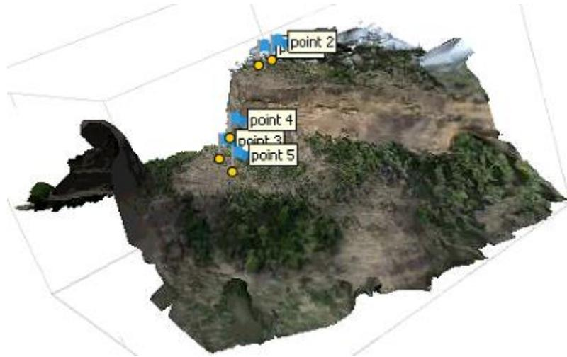
O próximo passo é eliminar as partes que não são de interesse no modelo e aplicar a última etapa do processamento, a texturização, o que irá proporcionar os mínimos detalhes gráficos do modelo 3D, como pode-se observar na figura 8.
