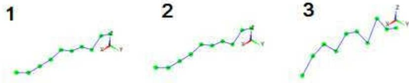
Figura 19. Análise dos modos de vibrar 1, 2 e 3, respectivamente, da Viga no OpenModal.
