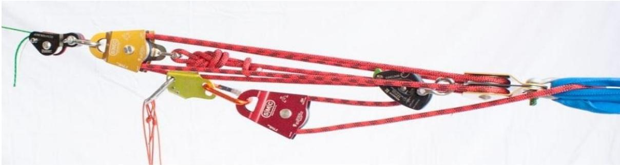
**Figura 6.** Sistema de redução (fita; linelock; polias; corda; manilhas; freio; acensor; sling).
