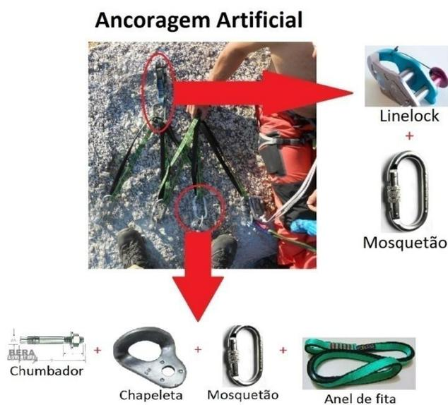
**Figura 2.** Ancoragem artificial e seus equipamentos
